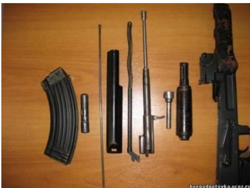
Сборка автомата после неполной разборки производится в обратной последовательности (после присоединения крышки ствольной коробки спустить курок с боевого взвода и поставить автомат на предохранитель).
